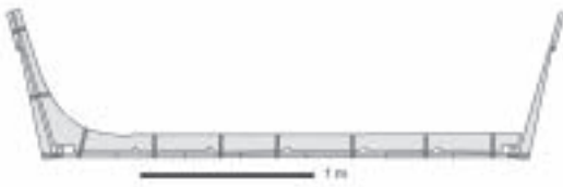
Abb. 3: Schematischer Querschnitt von Wrack 4 (Grafik O. Nakoinz).
